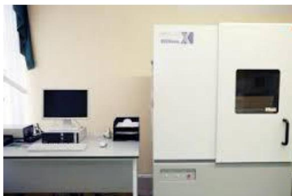
Figure 4: XRD 6000 Shimadzu type.
