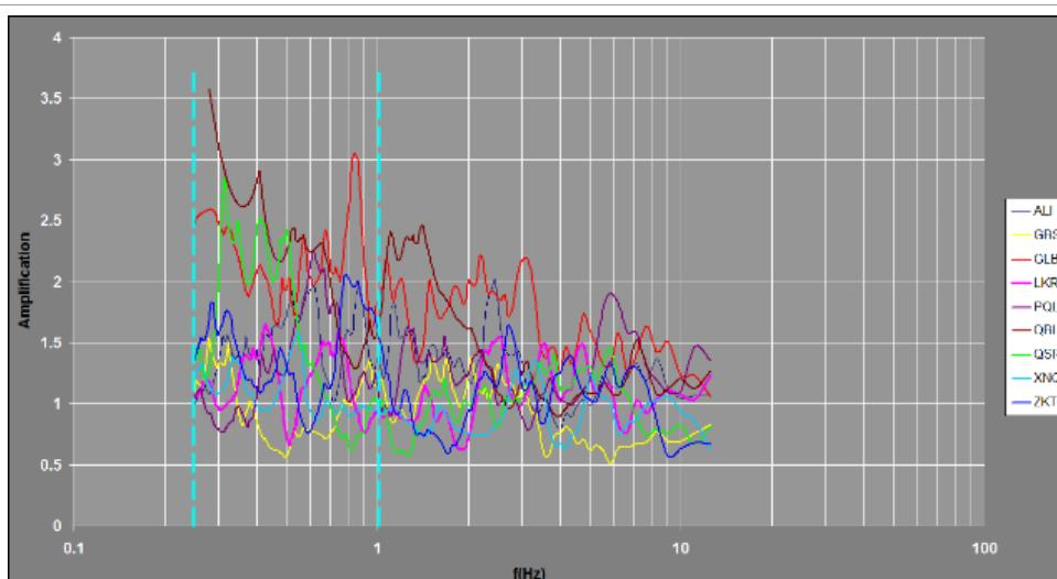
**Figure 5:** The amplification factor of the seismic wave on the stations of «ALI», «GBS», «GLB», «LKR», «PQL», «QBL», «QSR», «XNQ», «ZKT».
